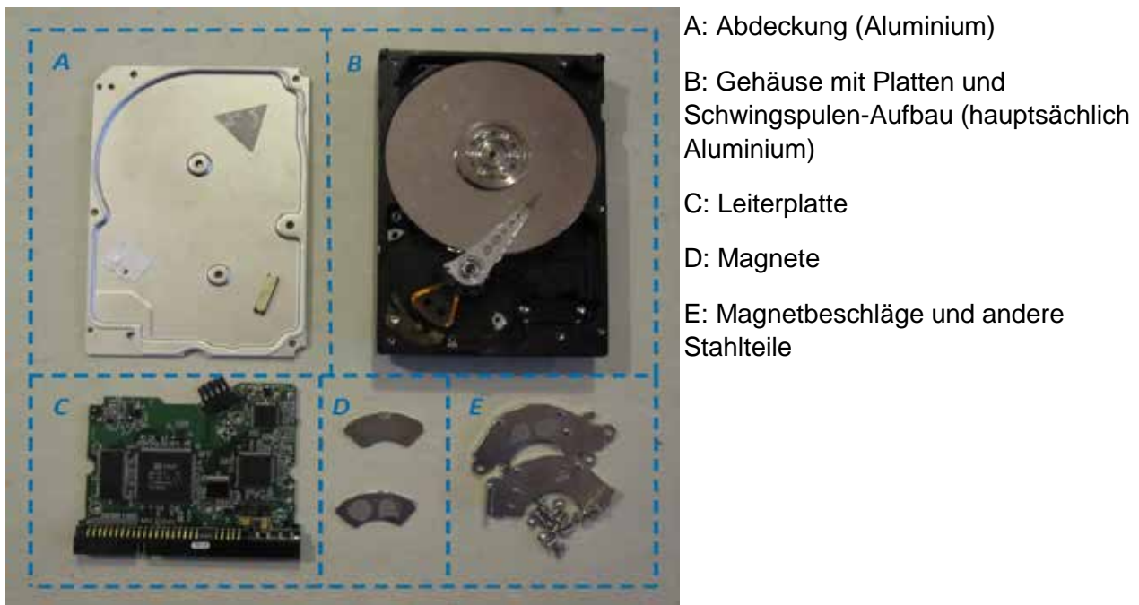
Abbildung 3-8: Demontage eines Computer-Festplattenlaufwerks
